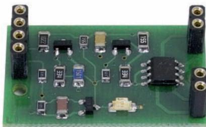
Плата изолятора кольцевого шлейфа, устанавливаемая в разъёмы на основной плате транспондера. Предназначена для отсечки участков линии, на которых возникли короткие замыкания.
