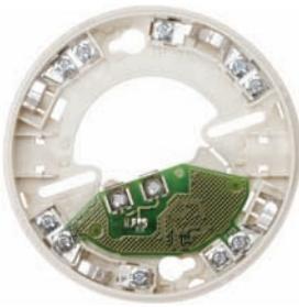
База с релейным выходом для извещателей IQ8Quad. Реле с сухим контактом Н.З. или Н.Р. (выбирается перемычкой). Заводская установка: Н.Р. контакт.
