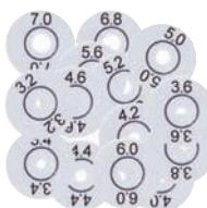
Наклейки для ограничения диаметра воздухозаборных отверстий в трубопроводах аспирационных систем. Наклейки располагаются поверх высверленных в трубопроводе отверстий для предовращения посторонних шумов, вызываемых работой аспирационной системы. Диаметр итогового отверстия указан на наклейке.
