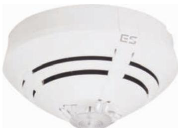
Оптический извещатель для раннего обнаружения пожаров, сопровождающихся выделением светлого дыма. Извещатель с децентрализованным интеллектом, автоматическим самотестированием, имеется возможность подключения выносного тревожного индикатора.
