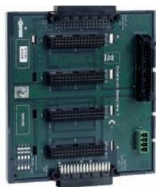
Платформа с соединительными разъёмами для установки до 4 функциональных модулей. Разъёмы для подключения клеммных блоков FX808435 и FX808436 (расположены справа).
