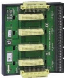
Платформа с соединительными разъёмами для установки до 4 функциональных модулей. При установке, модули автоматически защёлкиваются в слотах и могут заменяться без использования инструментов. При горизонтальной установке платформы, винтовые клеммы подключения расположены снизу, при вертикальной установке - справа.
