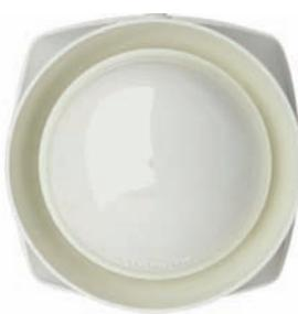
Адресное сигнальное устройство с питанием от шлейфа, соответствующее нормам EN 54-3. 20 программируемых тональных сигналов, включая DIN-тоны (по DIN 33404 часть 3). Громкость может быть выставлена по 8 уровням. Встроенный изолятор короткого замыкания. Синхронизация пуска. Плоский корпус позволяет оптимально адаптировать устройство под дизайн помещения. При использовании баз 806201 и 806202, может быть обеспечена защита от воздействия окружающей среды.
