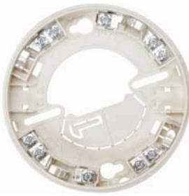
Стандартная база для установки любых извещателей серии IQ8Quad. При извлечении извещателя из базы, шлейф автоматически замыкается. База имеет дополнительный элемент, который может использоваться в случае необходимости, для защиты от несанкционированного снятия извещателя.
