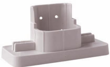
Кронштейн применяется для быстрого и надёжного крепления баз извещателей серии IQ8Quad, ES Detect, устройств тревожного оповещения и выносных индикаторов на подвесных потолках. Он позволяет сэкономить на применении специальных креплений для полых пространств, так как винты крепления базы могут быть вкручены непосредственно в отверстия монтажного кронштейна. Дополнительные преимущества монтажный адаптер дает при фиксации кабелей, жестких/гибких кабельных рукавов и кабельных связок.
