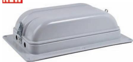
Рекомендуется использовать защитный кожух при установке измерительной камеры 781463 вне помещений, или на не отапливаемых чердаках для предотвращения образования конденсата. Установочное кольцо и кожух могут быть смонтированы на уже установленных измерительных камерах. Крышка кожуха легко снимается для проведения проверки и обслуживания системы.
