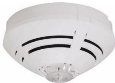
Оптический извещатель для раннего обнаружения пожаров, сопровождающихся выделением светлого дыма. Аналогово-адресный извещатель с децентрализованным интеллектом, автоматическим самотестированием, аварийным режимом, счётчиком тревог и часов наработки, индикатором тревоги/рабочего режима и программной адресацией.
