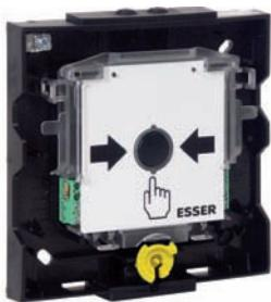
Адресный электронный модуль для подключения к кольцевым шлейфам типов esserbus и esserbus Plus. Фиксация кнопки и индикатор тревоги. Дополнительный вход для подключения шлейфа с неадресными извещателями. При подключении к неадресному шлейфу, работает как неадресный извещатель. Встроенный изолятр короткого замыкания. При отсутствии связи с КП, включается режим аварийной работы.
