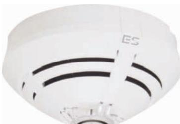
Автоматический извещатель тепла с быстрым полупроводниковым сенсором для обнаружения динамического роста температуры окружающей среды. Встроенный термомаксимальный сенсор для обнаружения пожаров с медленным повышением температуры. Извещатель с децентрализованным интеллектом, автоматическим самотестированием, имеется возможность подключения выносного тревожного индикатора.
