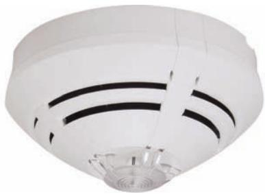
Мультисенсорный извещатель с интегрированным оптическим дымовым и тепловым сенсорами с временным анализом сигнала и оценкой комбинации данных от обоих сенсоров для обнаружения, как тлеющих возгораний, так и возгораний, сопровождающихся выбросом тепла. Аналогово-адресный извещатель с децентрализованным интеллектом, автоматическим самотестированием, аварийным режимом, счётчиком тревог и часов наработки, индикатором тревоги/рабочего режима и программной адресацией.
