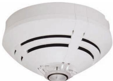
Автоматический извещатель тепла с быстрым полупроводниковым сенсором для обнаружения возгораний, связанных с выделением тепла. Аналогово-адресный извещатель с децентрализованным интеллектом, автоматическим самотестированием, аварийным режимом, счётчиком тревог и часов наработки, индикатором тревоги/рабочего режима и программной адресацией.
