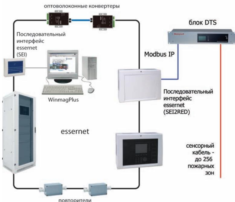
При помощи модуля SEI2RED, блок DTS может быть интегрирован в сеть essernet в качестве полноценной панели пожарной сигнализации с возможностью идентификации до 256 пожарных зон в каждом канале обнаружения с выдачей сигналов "Пожар", "Техническая тревога", "Неисправность", с возможностью сбрасывать сигналы и временно отключать отдельные зоны обнаружения.
