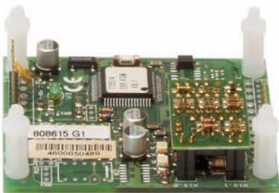
Транспондер обеспечивает интеграцию панели пожаротушения 8010 в кольцевой шлейф пожарных панелей серии FlexES Control, позволяя объединять в сеть несколько зон тушения. На каждый кольцевой шлейф можно подключить до 8 панелей 8010. Все индикаторы и выходы могут активизироваться по команде пожарных панелей. Транспондер занимает один адрес на шлейфе.
