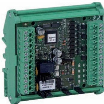
Корпус в сборе с установленным транспондером
