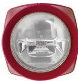
Адресное сигнальное устройство с питанием от шлейфа, соответствующее нормам EN 54-3 и EN-54-23. 20 программируемых тональных сигналов, включая DIN-тоны (по DIN 33404 часть 3). Громкость может быть выставлена по 8 уровням.
