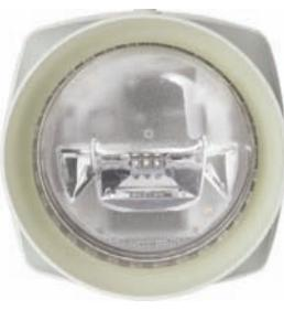
Адресное сигнальное устройство с питанием от шлейфа, соответствующее нормам EN-54-23. Оптический сигнализатор параметрируется посредством П/О tools8000 под помещения различной площади - от W-2.4-5 (высота установки 2,4 м, световая площадь 5x5 м) до W-3.6-8 (высота установки 3,6 м, световая площадь 8x8 м).
