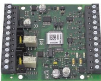
Как 808623, но с двухпороговыми входами и возможностью выдачи сигнала предтревоги. Может применяться со специальными извещателями, например, аспирационными.
