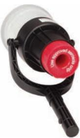
Тестер предназначен для проверки дымовых извещателей серий IQ8Quad и ES Detect. Работоспособность измерительной камеры и цепей обработки сигнала проверяется впрыскиванием тестового аэрозоля. Тестер крепится на телескопическую штангу (арт.№ 060427).
