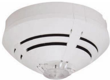
Оптико-тепловой извещатель IQ8Quad для использования в измерительной камере 781443. Извещатель используется для обнаружения как тлеющих возгораний, так и возгораний, сопровождающихся выбросом тепла. Извещатель также способен распознавать мелкие частицы дыма и аэрозольные продукты горения, ранее обнаруживавшиеся только при использовании ионизационных извещателей. Извещатель снабжён встроенным изолятором кольцевого шлейфа.
