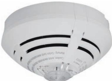
Дымовой извещатель для раннего обнаружения пожаров. Аналогово-адресный извещатель с дистанционным интеллектом, автоматическим самотестированием, аварийным режимом, внутренней памятью. Индикация тревоги. Программная адресация и ВУОС могут использоваться только с esserbus / esserbus-Plus. Извещатель без изолятора короткого замыкания, специально для применения во взрывоопасных областях. Работает в неадресном режиме на стандартном шлейфе совместно с искрогасящим барьером 764744.
