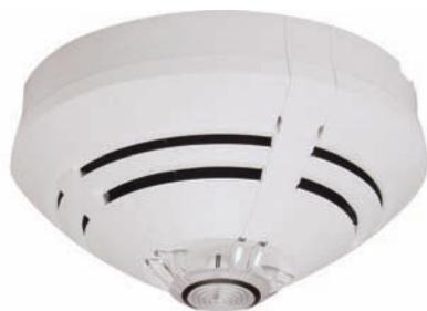
Автоматический извещатель тепла с быстрым полупроводниковым сенсором для обнаружения динамического роста температуры окружающей среды. Встроенный термомаксимальный сенсор для обнаружения пожаров с медленным повышенiem температуры. Аналогово-адресный извещатель с децентрализованным интеллектом, автоматическим самотестированием, аварийным режимом, счётчиком тревог и часов наработки, индикатором тревоги/рабочего режима и программной адресацией.
