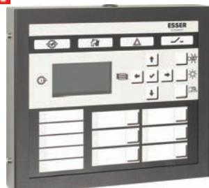
Панель-повторитель с пультом управления для контрольной панели FlexEs Control. Имеет стандартные кнопки управления и 6 свободно программируемых кнопок, светодиодные индикаторы и графический 6-строчный ЖК-дисплей. Подключается к панели FlexEs Control через интерфейс RS-485.
