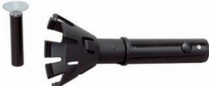
Пригоден для извлечения из баз извещателей серий IQ8Quad и ES Detect. С использованием дополнительной вставки с присоской, возможен как съем, так и установка защитных колпаков для извещателей и баз (поз. 805588, 805589 и 805587). Съемник устанавливается на телескопическую штангу арт. №060426 и 060247, а также на 769813 с адаптером 805581.
