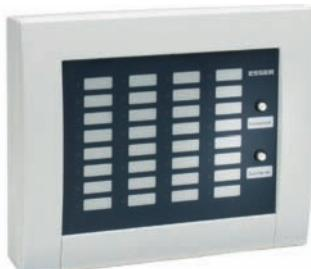
Выносная индикационная панель на 32 сигнала. Сигналы могут свободно программироваться задаваться как для индивидуальных элементов, входов и выходов, так и групп извещателей. Табло работает на основе транспондера esserbus на 32 выхода оптопары и подключается к кольцевому шлейфу типа esserbus или esserbus PPlus. Кнопки для тестирования светодиодных индикаторов и сброса встроенного зуммера. Элегантный пластиковый корпус для настенного монтажа.
