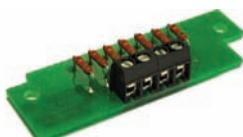
**Обогревательный элемент для датчиков IQ8Quad**
