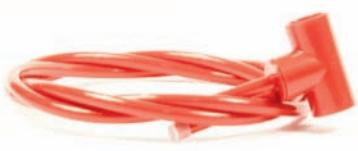
Капиллярная трубка с торцевым наконечником. Позволяет отвести воздухозаборное отверстие от основной воздухозаборной трубы. Применимо для защиты отдельных шкафов аппаратуры или организации скрытой установки воздухозаборных труб
